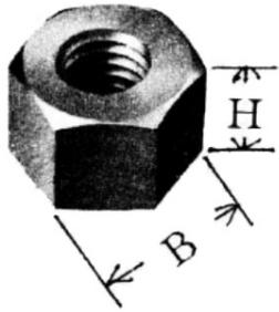
厚みがねじ径と同じで強い締め付け力が得られます ミリネジ材質 SCM435 熱処理品
